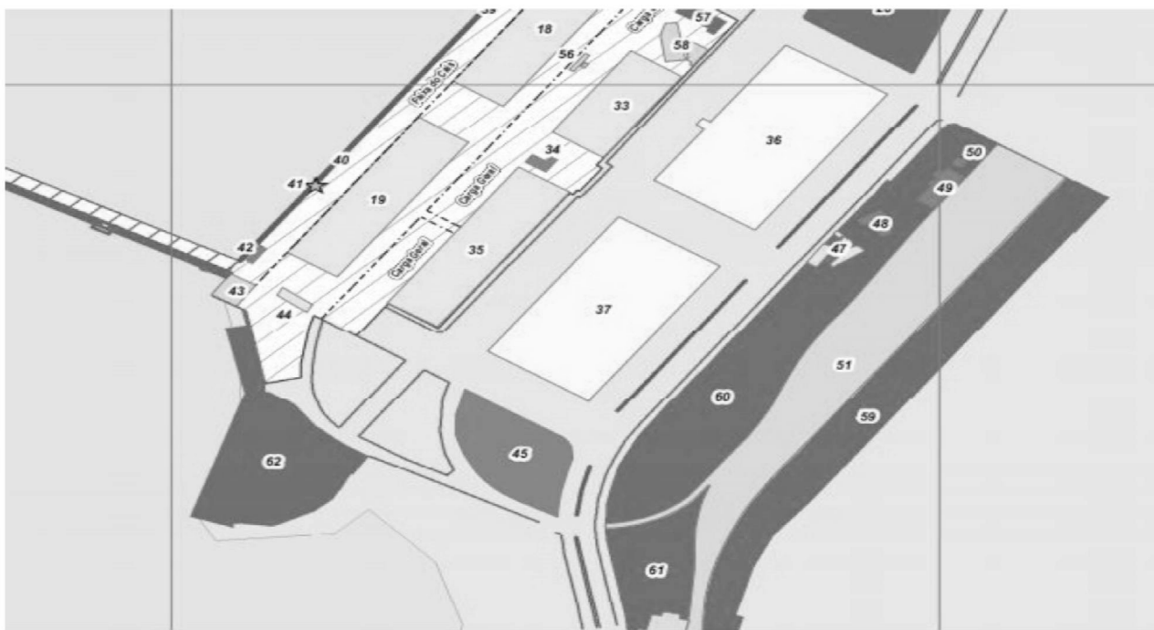
Figura 7– Levantamento topográfico georreferenciado do Porto de Fortaleza
